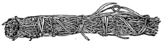
b) Fio de rotor (Fiação "open end")
